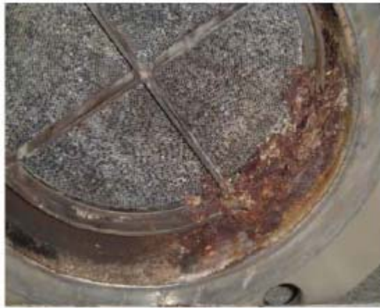
Abbildung 3-33: Funktionsbeeinträchtigung des Katalysators durch Kondensatausfall, [56]
