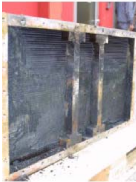
Abbildung 3-31: Verblockung der Austrittsseite des Gemischkühlers, [56]
