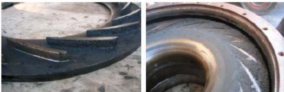
Abbildung 3-30: Ablagerungen von Koks- und Teerbestandteilen im Diffusorgehäuse, [56]
