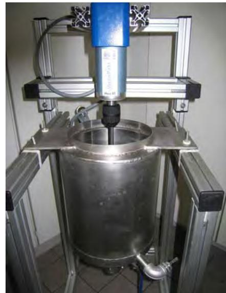
Abbildung 3: Makroviskosimeter
