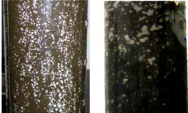
Abbildung 11: Unterschiedliche Gasblasen in den Fermenterproben (BGA Reidling - links, BGA Strem – rechts)
